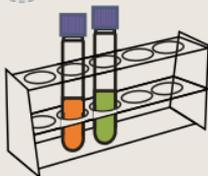
将摇晃后的试管放置试管架上静置7分钟。
