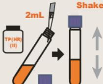
每支冷却好的试管中加入2mL TP(HR)(II) 试剂并摇晃。
