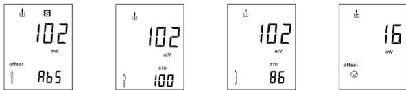
将电极头部置于标准溶液中，待数据稳定，液晶顶部会显示稳定的图标，按 键确认。此时仪表会显示STD字样，下排显示要校准的标准值，按 键或 键调节该值至标准值，按 键确认，若正常则结束该点的校准进入电极偏移量显示画面，若出错则会显示ERR作为提示。用户也可以直接按 键不校准，直接回到测量模式。
