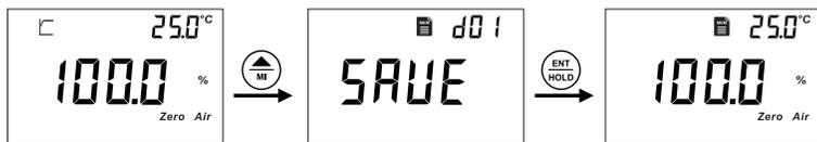
1、在测量数据稳定后用户如需保存，按 键在仪表的右上方会显示所保存的批次，然后按 键确认保存数据，或按 键不保存返回测量。保存完成后仪表自动返回到测量状态。数据最多保存120组。超出时仪表会显示OVER表示存储器已满。
