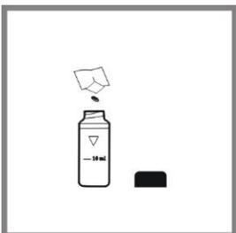
8、加一包余氯或总氯试剂于比色管中，摇匀至试剂完全溶解，静置 30 秒，若瓶壁上有气泡，缓慢颠倒比色瓶直至气泡消失。
