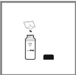
7、将纯水倒出，用待测水样润洗 1-2 次比色瓶，将水样倒出，加一包臭氧试剂于比色管中。
