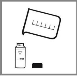
7、将纯水倒出，用待测水样润洗 1-2 次比色瓶，加待测水样至比色管的 10mL 刻度线。
