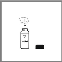
9、加入一包二氧化氯 (II) 试剂，摇匀至完全溶解，静置 30 秒，若瓶壁上有气泡，缓慢颠倒比色瓶直至气泡消失。
