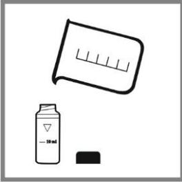
8、加待测水样至比色管的 10mL 刻度线，旋紧样品管盖，摇匀至臭氧试剂完全溶解，静置 30 秒，若瓶壁上有气泡，缓慢颠倒比色瓶直至气泡消失。
